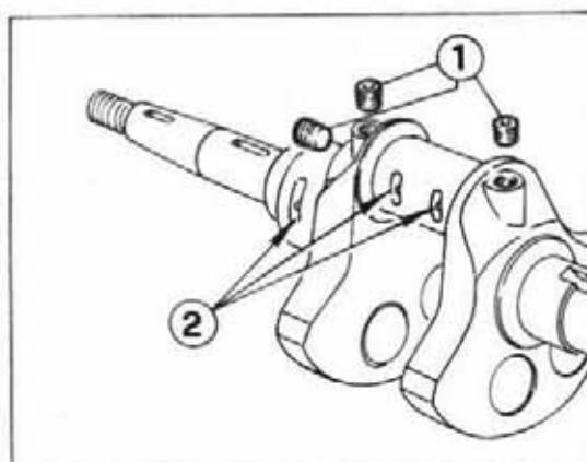
Rimuovere i tappi (1) a vite ed effettuare una accurata pulizia delle canalizzazioni (2) di lubrificazione. Mettere alcune gocce di "Loctite 242" sia sulla filettatura del tappo che chiude il foro interno del perno di biello che sui tre tappi filettati e rimontare.
