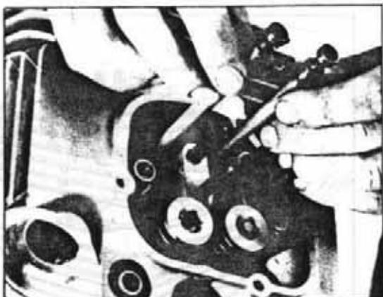
Svitare la vite a testa cilindrica con cava esagonale (brugola) posta in corrispondenza del vano di passaggio delle astine.
