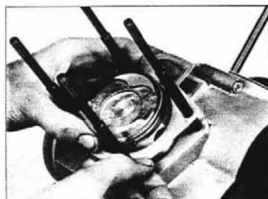
Installare la guarnizione di base del cilindro avendo cura di cospargerla di un sottile strato di composto di tenuta ("Three Bond 1215").
