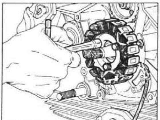
Montare lo statore posizionandolo in modo che il cavo risulti in basso. Serrare le tre viti di fissaggio.
