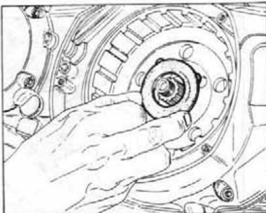
Montare il mozzo della frizione, installare sull'elbero una rondella di sicurezza nuova e il dado.
