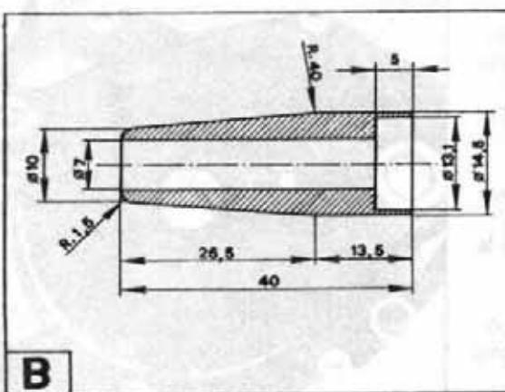
**Modello 500:** installare sull'estremità dell'albero primario una boccia conica (A) di protezione realizzata come da disegno quotato.
