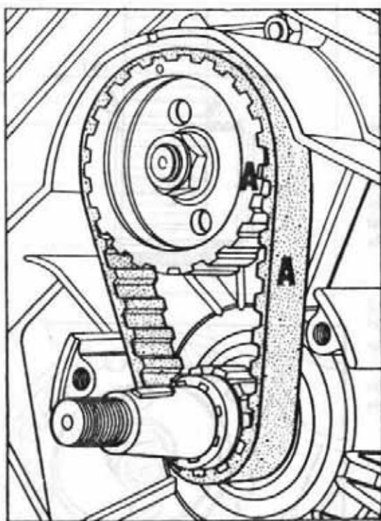
Se si utilizza la cinghietta montata in precedenza, occorre disporla nella stessa posizione in cui essa si trovava prima dello smontaggio.
