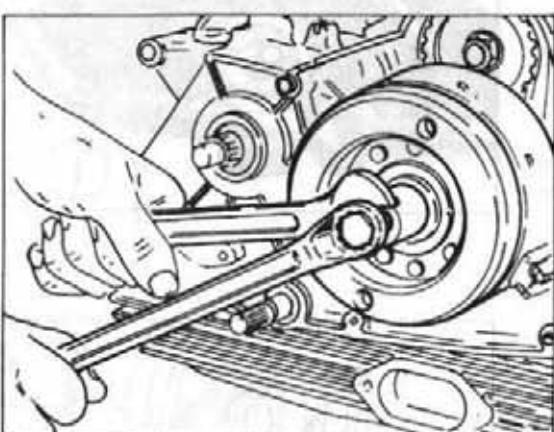
Rimuovere quindi il rotore del generatore dall'albero motore utilizzando l'estrattore N° **49.01.77**. Controllare che la chiavetta alloggiata in una scanalatura sul cono dell'albero motore sia in buone condizioni e saldamente fissata nella propria sede.
