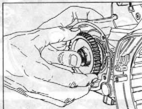
Sfilare l'ingranaggio avviamento con la ruota libera unitamente all'ingranaggio "duplex". Recuperare i rasamenti. Svitare le viti che lo fissano al basamento e rimuovere il coperchio laterale sinistro del motore, completo di campana frizione e ingranaggio condotto della trasmissione primaria.
