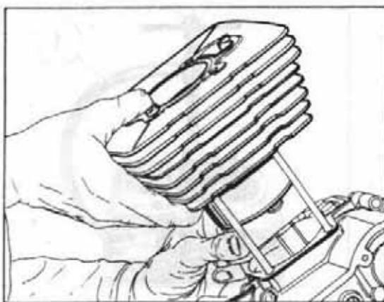
**Rimozione del cilindro.**
