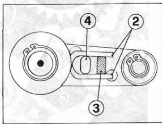
Entrambe le estremità (2) della molletta del selettore devono essere in contatto sia con l'appendice (4) della leva di comando selezionatore che con quella (3) della piastra di fermo del meccanismo di azionamento del selettore.
