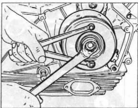
Per svitare il dado di fissaggio del rotore del generatore è necessario bloccare il rotore stesso per mezzo della chiave a compasso (USAG 281C/260).
