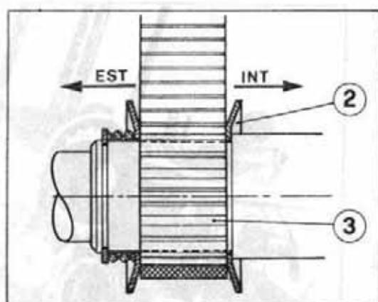
Installare sull'albero motore la rondella interna (2) disponendola con il labbro piegato verso il carter e montare quindi il rocchetto dentato (3) avendo cura di installarlo con il segno di riferimento (A) esistente su di esso rivolto verso l'esterno ed in corrispondenza della cava che alloggia la chiavetta.
