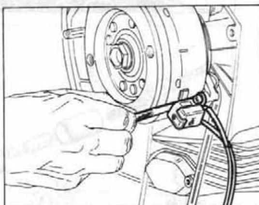
Remonter le rotor. Attention: la clavette doit être correctement mise en place sur le vilebrequin; de plus, avant de remonter le rotor, les deux surfaces coniques (de l'arbre et du moteur) doivent être soigneusement dégraissées à l'aide d'un chiffon propre et de trichloréthylène.
