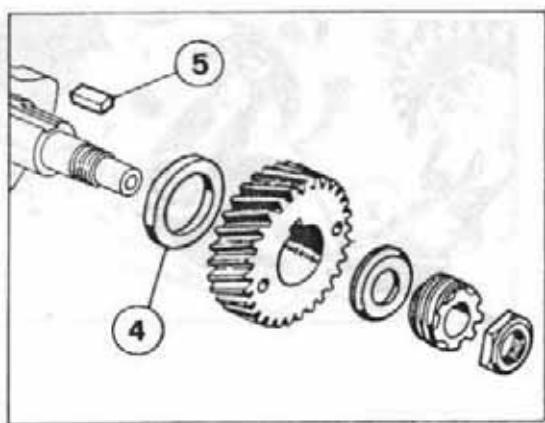
Sfilare dall'albero motore l'ingranaggio di comando della pompa olio, il distanziale, l'ingranaggio conduttore della trasmissione primaria ed il distanziale (4) interposto tra di esso e l'anello interno del cuscinetto di banco sinistro (solo 500 cc). Rimuovere la chiavetta (5).
