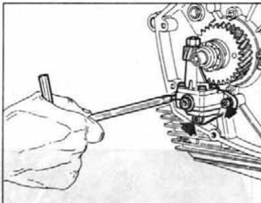
Bloccare l'ingranaggio conduttore della trasmissione primaria per mezzo dell'attrezzo speciale (1) N° 49.01.69 e svitare la ghiera autobloccante, utilizzando l'attrezzo (2) N° 49.01.67 ed una chiave da 24 mm (3).
