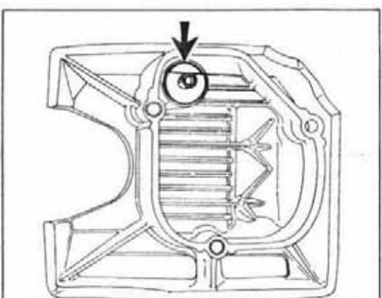
Rimontare il coperchio della testata dopo essersi accertati che la guarnizione sia in perfetta stato; controllare che il labirinto dello sfioro sia disposto correttamente e che la molletta sia al proprio posto.
