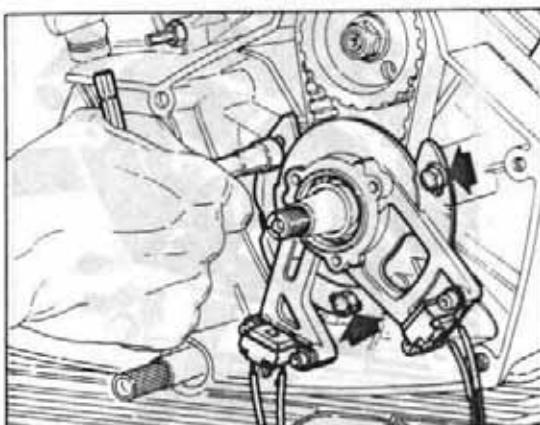
Sfilare dall'albero motore la corta molla cilindrica (1) (posta tra il rotore del generatore ed il roccetto della cinghietta dentata (2)).
