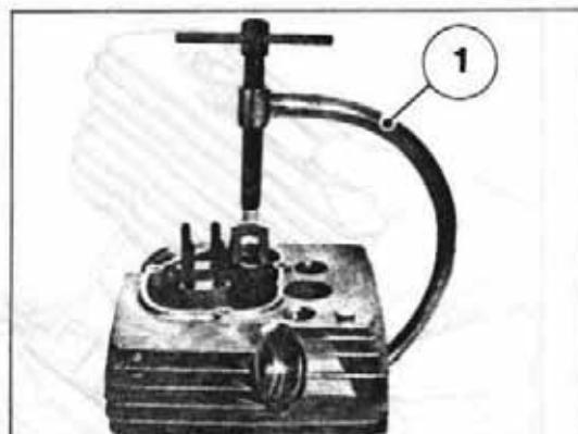
Dopo lo smontaggio tenere separata ogni valvola, unitamente al proprio scodellino (2) ed alla propria coppia di semiconi (3).
