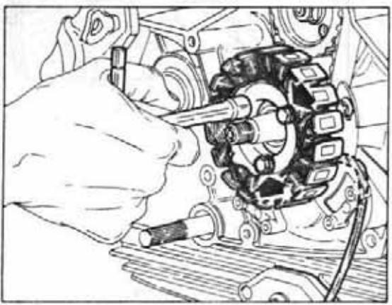
Togliere le tre viti di fissaggio e rimuovere lo stator del generatore.
