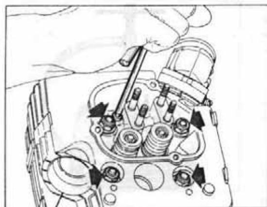
Avvitare quindi la vite a testa cilindrica con cava esagonale (brugola) alloggiata nel passaggio delle astine.
